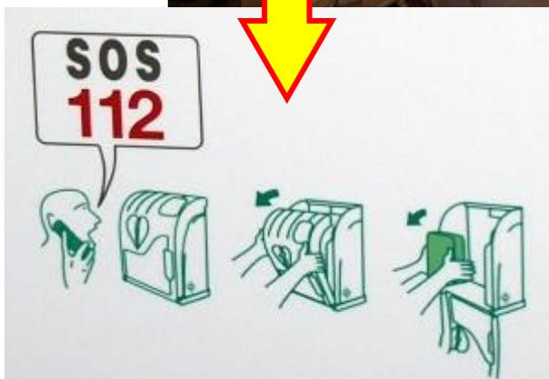
Auf dem Aufbewahrungskasten befindet sich eine Kurzanleitung zum öffnen - vorher Notruf schicken. Nach dem entnehmen des Defibrillator ist für jeden Laien eine sicher Beschreibung zur Lebensrettung ersichtlich.
